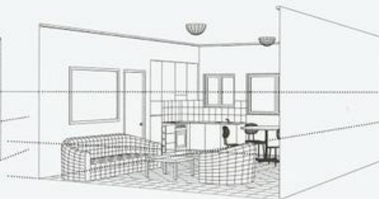
4 Perspectivă de interior la două puncte de fugă. Încercarea de a înfățișa a treia latură a spațiului obturează o parte din desen.
